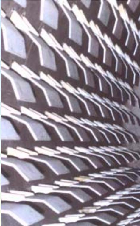
Intérieur d'un sécheur à tambour
